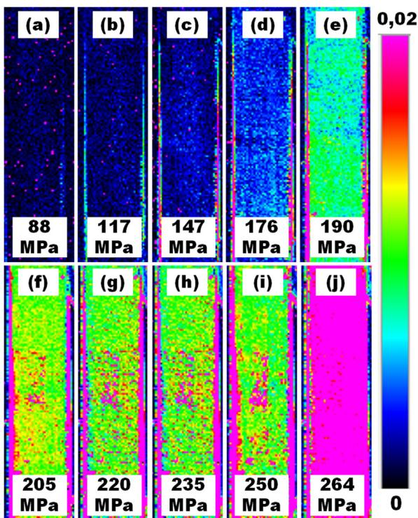
Fig. 7. Thermographs of SiC/BMAS.
